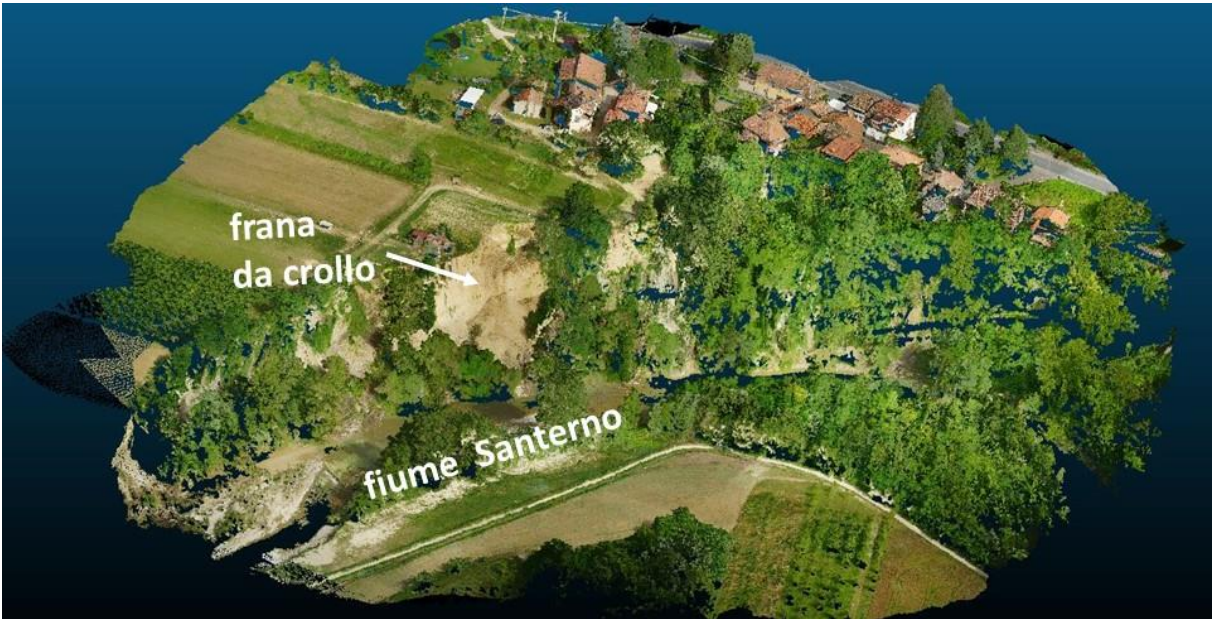
Figura 29: Nuvola di punti derivata da rilievo LiDAR in località Fontanelice (Villa S. Giovanni, BO). Le frane da crollo sono state innescate dai processi erosivi spondali durante la piena del fiume Santerno.
