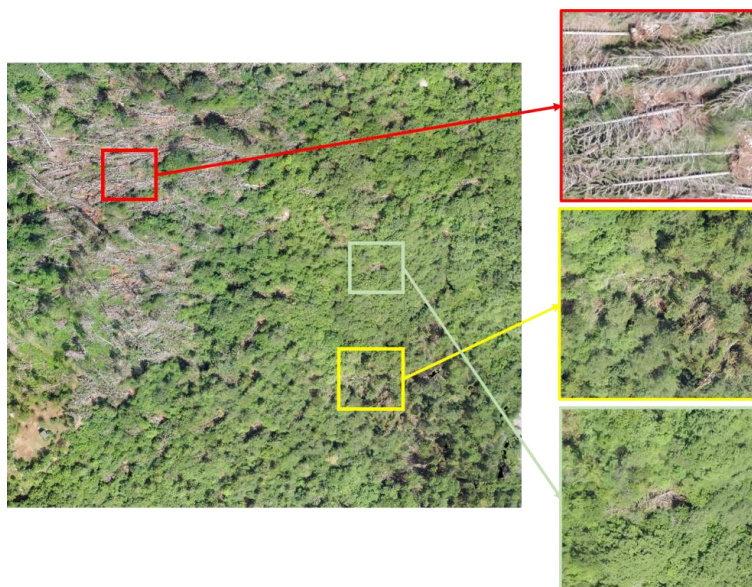
Figura 13: esempio di prodotto cartografico e analisi del rilievo da drone ad ala fissa (Valtrompia, BS) in una vasta area forestale con estesi danneggiamenti a seguito della tempesta Vaia. Si riporta una porzione estratta dall'ortomosaico realizzato (con risoluzione a terra 3 cm), con identificazione di areali forestali con diverso livello di impatto.
