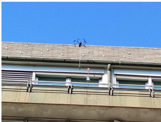
Figura 93: configurazione di misura con sensore ancorato a 100 cm sotto il velivolo.
