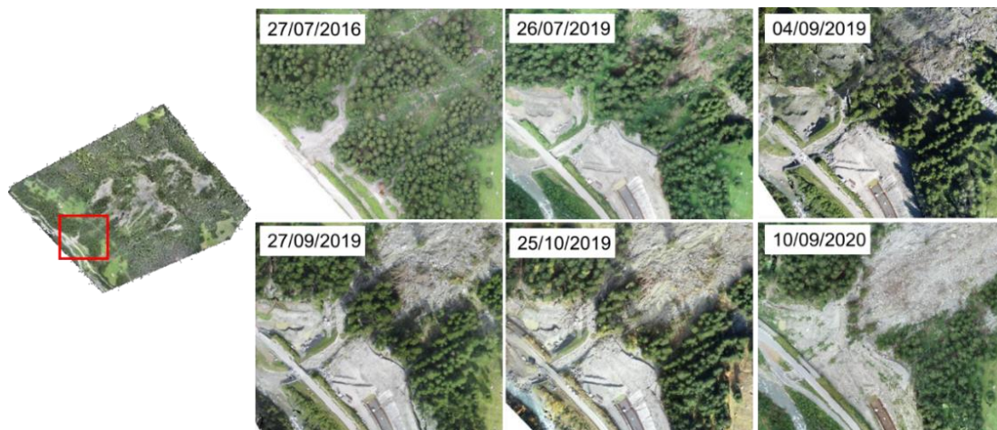
Figura 20: frana del Ruinon (SO). Analisi della dinamica evolutiva con individuazione degli spostamenti superficiali di singoli blocchi individuati nelle diverse date di rilievo.
