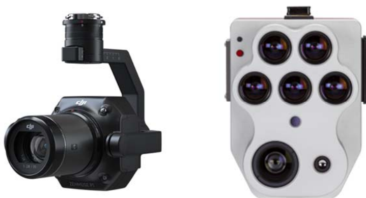
Figura 2: sensori passivi disponibili per l'uso con i sistemi UAS. A sinistra: fotocamera RGB per acquisizioni di immagini a scopo di documentazione o per fotogrammetria; a destra: sensore multispettrale.
