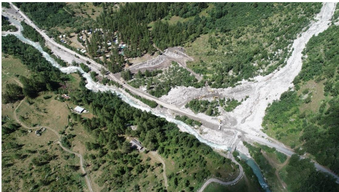
Figura 24: colata detritica del 2019 sul Torrente Margueraz in Val Ferret (Courmayeur, AO). Originatasi a oltre 2.100 m di quota ha interessato la strada di fondovalle, alcune automobili e ponti. Il rilievo rapido ed accurato tramite UAS, oltre a consentire il rapid assessment dell'evento per la riduzione del rischio residuo, ha permesso la stima del volume del materiale da rimuovere.
