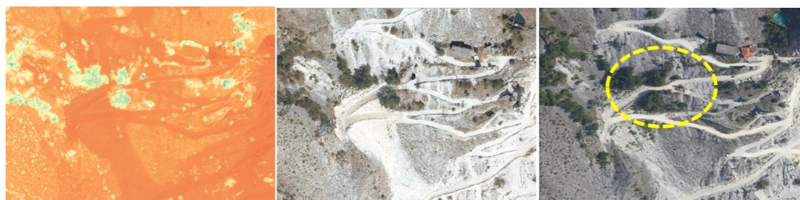
Figura 80: vegetazione riparia e accumulo di fanghi di segazione (marmettola). A sinistra: dettaglio del tratto rilevato con UAS e LiDAR terrestre. Al centro: modello del terreno da rilievo LiDAR terrestre. A destra: ortomosaico da UAS, con evidenziate le aree maggiormente soggette ad accumulo di marmettola a causa dei processi di trasporto solido.
