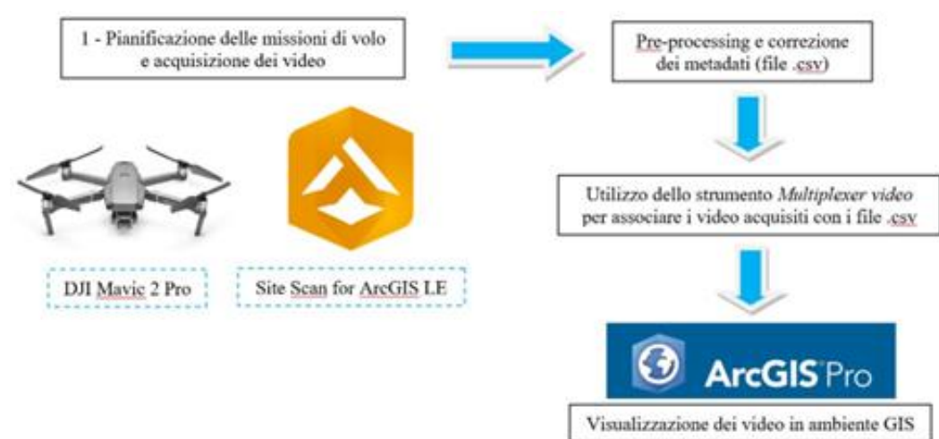
Figura 41: workflow per l'acquisizione e la visualizzazione dei video in ArcGIS Pro.
