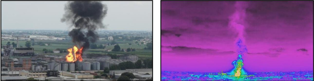
Figura 88: vista BSB per l'individuazione di un nuovo innesco dovuto a materiale infiammabile.
