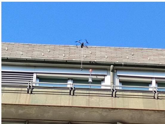
Figura 94: configurazione come da immagine precedente ed effetto delle diverse fasi di funzionamento sui valori di campo (interferenze): fase 1 – UAS spento, fase 2 – UAS acceso a terra e motori spenti, fase 3 – UAS acceso a terra e motori in rotazione al minimo, Fase 4 – UAS acceso in aria in hovering.
