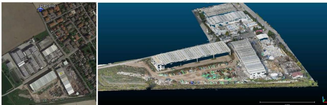
Figura 74: un esempio dei risultati di un rilievo da drone effettuato nell'ambito di un controllo ordinario presso un impianto di trattamento di rifiuti: la tecnica fotogrammetrica ha consentito l'individuazione e la stima accurata della disposizione dei diversi cumuli, ed il loro computo volumetrico.
