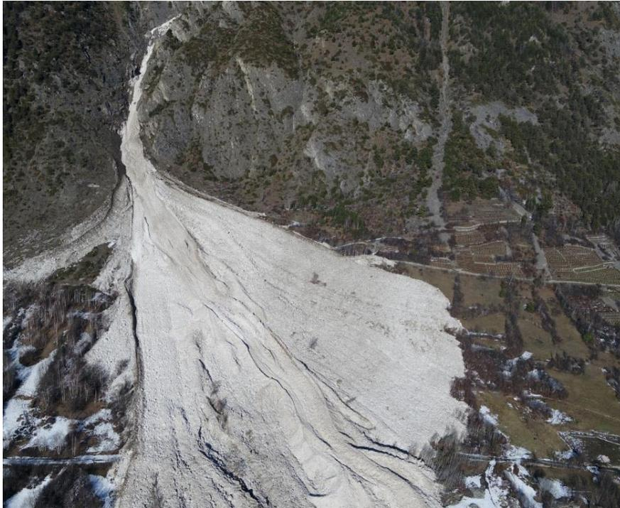
Figura 31: ortomosaico RGB della valanga e stima degli spessori degli accumuli, in prossimità della Fraz. Diailley (Morgex, AO), computati sulla base del DSM derivato in post-evento.
