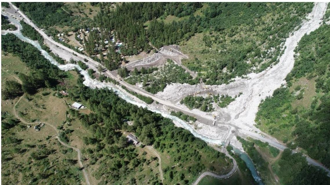
Figura 25: colata detritica sul Torrente Montitaz (2024) in Val Ferret (Courmayeur, AO). Per la valutazione dell'impatto sulle strutture o il censimento dei danni e lo stato delle opere si ricorre a rilievi di dettaglio con UAS multirotori tramite missioni manuali.
