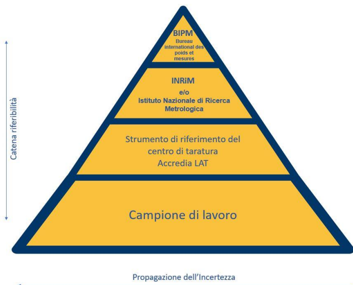
Figura 6.2: Catena di riferibilità vs propagazione dell'incertezza.
