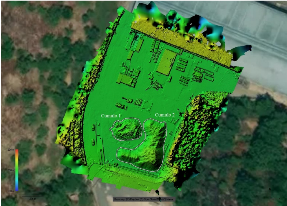
Figura 9: Modello digitale di superficie (DSM), raffigurati in bianco i poligoni utilizzati per la stima del volume occupato dalle macerie
