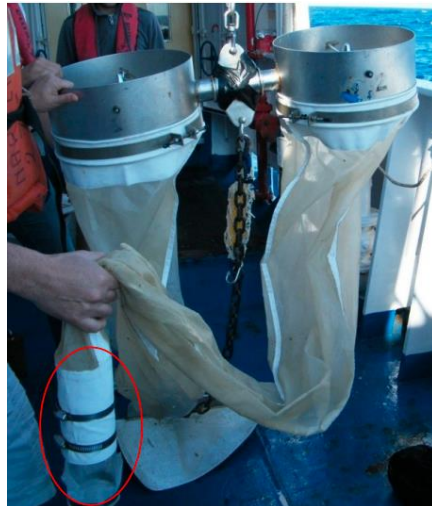
Figura 3 - Campionatore Bongo 40 con depressore
