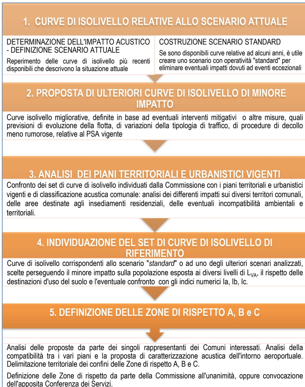
Figura 8. Schema metodologico per la definizione delle zone di rispetto A; B e C.
