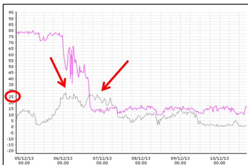
Figura 8.30 – Confronto tra l'andamento del manto nevoso (in viola) e la velocità del vento (in grigio). Si evidenzia come il forte vento registrato sia responsabile dell'erosione completa del manto nevoso.
