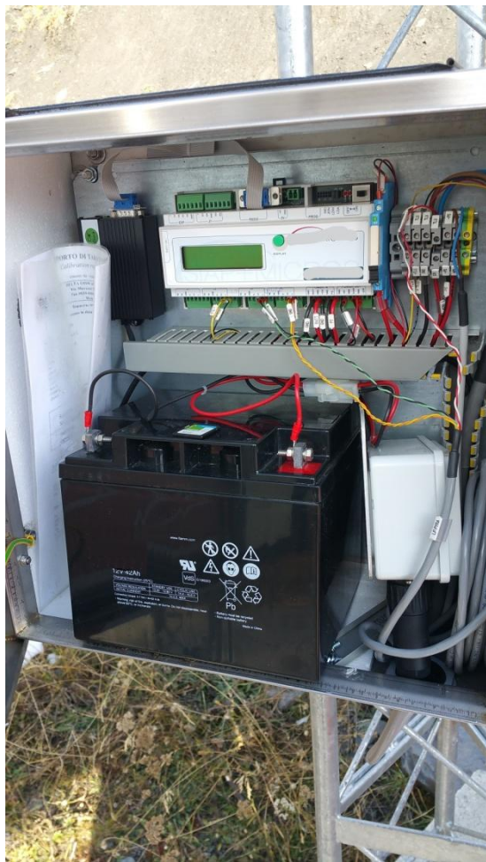
Figura A.51 - Esempio di datalogger con schermo LCD, con un numero di canali idonei per una installazione più semplice, dotato di diverse porte di comunicazione e slot per espansione memoria con SD Card. Fonte: archivio Attività geologiche – Regione Autonoma Valle d'Aosta
