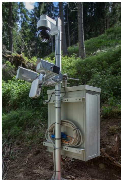
Figura A.18 – Esempi di sistemi radar doppler per l'allertamento in tempo reale di fenomeni di dissesto idrogeologico a cinematica rapida. Fonte: archivio UNIFI
