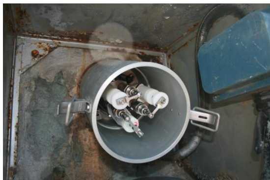
Figura 36 – Estensimetro multibase automatico – loc. Campo Frascaia (Lanzada – SO). Fonte: archivio CMG Arpa Lombardia
