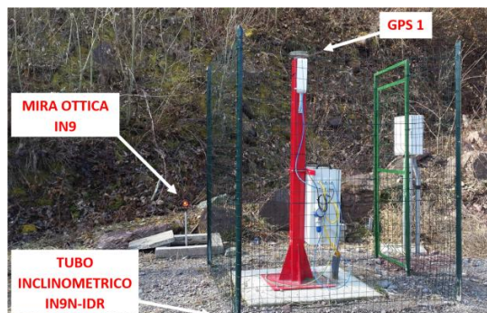
Figura 2 – Esempio di ridondanza dei sistemi di misura del movimento del dissesto di Idro (BS). Sensore GNSS con acquisizione in tempo reale, mira ottica afferente al sistema di misurazione topografica manuale e tubo inclinometrico con cavo TDR ( time domain reflectrometry ). Fonte: archivio CMG Arpa Lombardia
