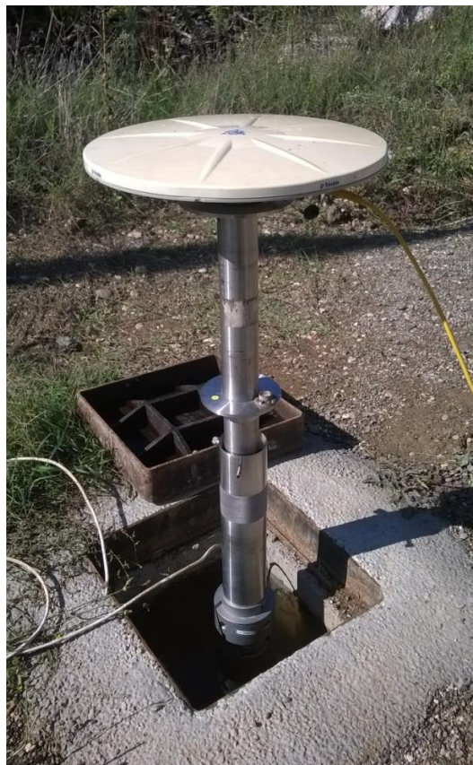
Figura A.14 - Antenna posizionata sulla testa di un inclinometro (Frana di Costa della Gaveta-PZ). Foto da archivio GEO-GFI ISPRA
