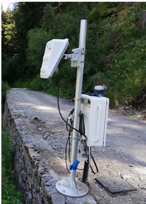
Figura A.18 – Esempi di sistemi radar doppler per l'allertamento in tempo reale di fenomeni di dissesto idrogeologico a cinematica rapida. Fonte: archivio UNIFI
