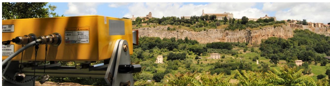
Figura C.19 - Veduta del lato SE della rupe di Orvieto e del pendio argilloso sottostante. In primo piano un radar per misure interferometriche da terra (Fonte: foto Filippo Soccodato)
