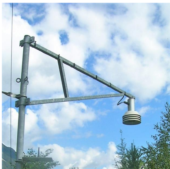
Figura A.49 - Esempio di nivometro. Valdisotto (SO). Fonte: archivio CMG Arpa Lombardia
