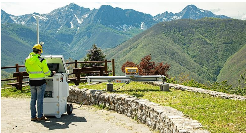
Figura 11 – Monitoraggio con radar interferometrico
