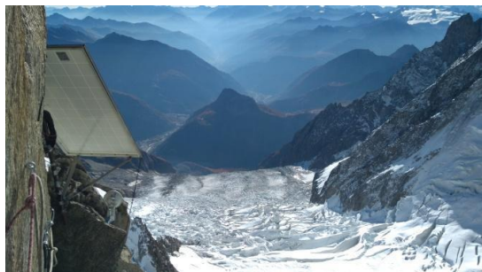
Figura 52 - Esempio di installazione di comunicazione punto-punto in UHF (antenna a parabola bidirezionale in basso) per la trasmissione di dati accelerometrici dalla cresta della Brenva nel Massiccio del Monte Bianco. Fonte: archivio Attività geologiche – Regione Autonoma Valle d'Aosta
