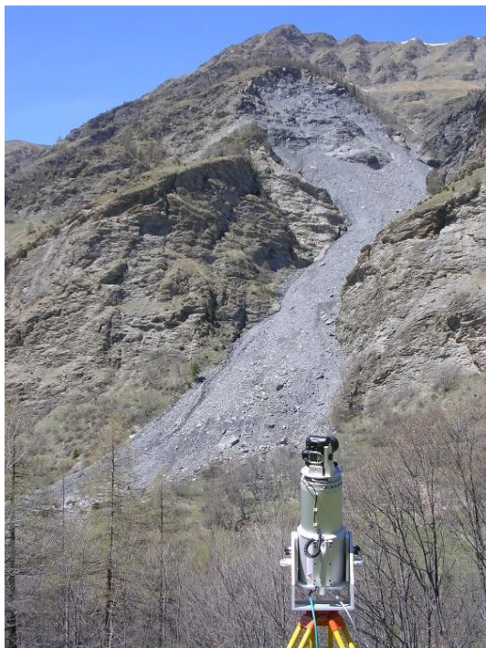
Figura 9 – Rilevamento con Lidar terrestre della frana di Le Ayas (TO - archivio CNR IRPI)
