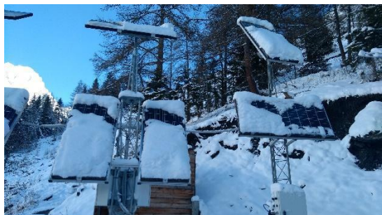
Figura A.53 - Tipico problema di zone di alta montagna, in cui i pannelli possono essere ricoperti di una coltre nevosa che ne impedisce il corretto funzionamento. Fonte: archivio Attività geologiche – Regione Autonoma Valle d'Aosta
