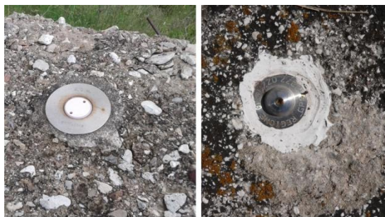
Figura A.13 - Caposaldo autocentrante di ISPRa (a sinistra) e centrino della Regione Abruzzo (a destra). Fonte: archivio GEO-GFI ISPRa
