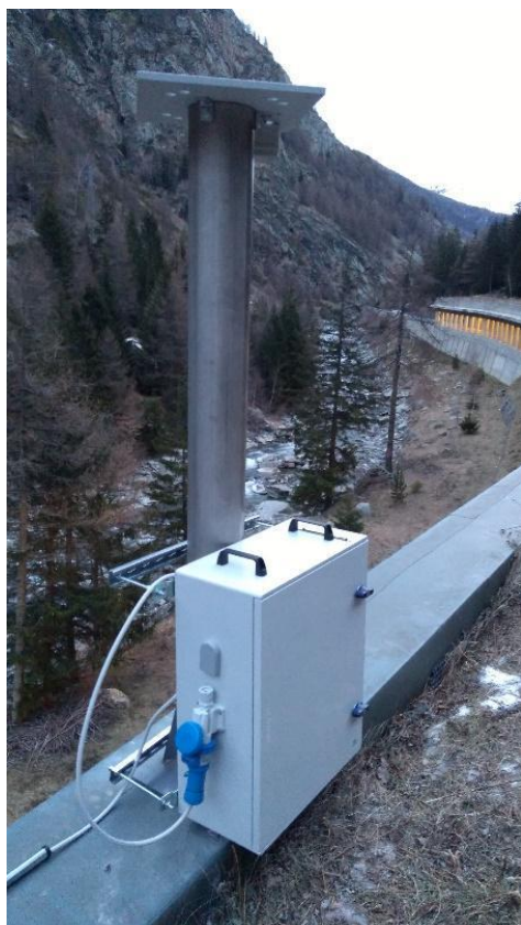
Figura 48 – Alimentazione da rete, con impianto realizzato ad hoc dall'impianto di illuminazione di una galleria su Strada Regionale. Fonte: archivio Attività geologiche – Regione Autonoma Valle d'Aosta
