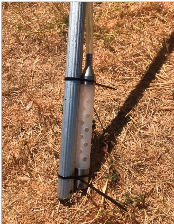
Foto 4 – particolare asta telescopica con tubazione linea campionamento (Fonte UO REMIC Dip. CE)
