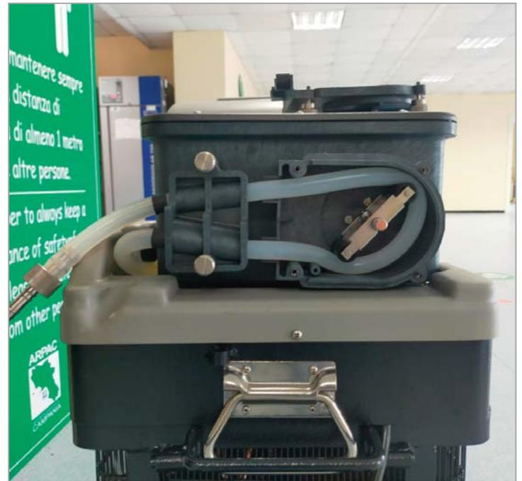
Foto 1 - Particolare pompa peristaltica (Fonte: UO REMIC Dip. CE)
