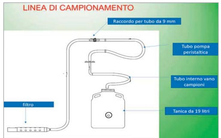
Foto 3 - Linea di campionamento base estrapolata dal Manuale ISCO (Fonte: UO REMIC Dip. CE)
