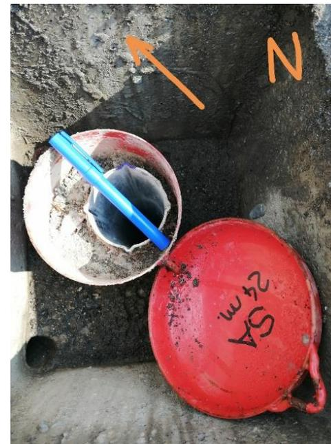
Gli spostamenti nel terreno sono determinati attraverso la comparazione delle **misure di esercizio**, ripetute nel tempo, rispetto alla **misura di zero** (posizione iniziale).
