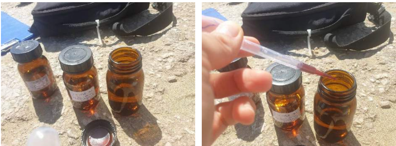
Figura 3: Fasi preparative del campione; a sinistra contenitori in vetro scuro e a destra fissazione in campo dei campioni raccolti.
