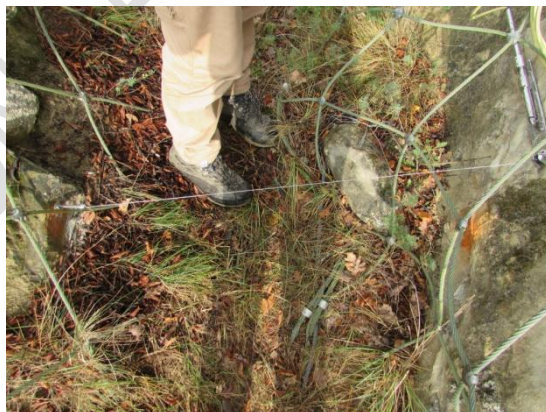
Figura A.5 - Deformometro elettrico, parete rocciosa "Rocce di Vignola" – Ponte Nizza (PV). A destra (lato di monte frattura) si osserva la piastra di fissaggio che ospita la carrucola, la testa di misura e il corpo sensore, a sinistra l'ancoraggio di valle del filo in kevlar. La frattura mostra un'apertura alla base di circa 1,5 m. Fonte: archivio CMG Arpa Lombardia
