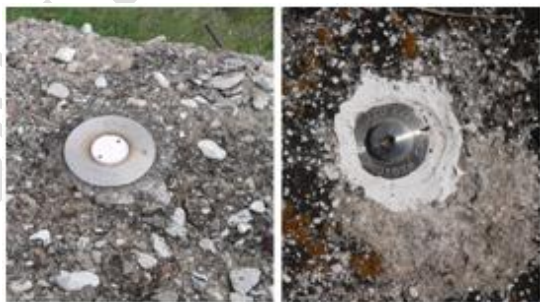
Figura A.13 - Caposaldo autocentrante di ISPRa (a sinistra) e centrino della Regione Abruzzo (a destra). Fonte: archivio GEO-GFI ISPRa
