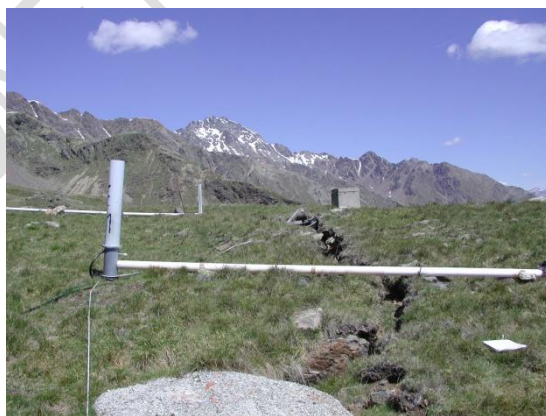
Figura A.2 - Estensimetro a filo protetto da tubo in pvc, vertice frana di Val Pola- Valdisotto (SO). Fonte: archivio CMG Arpa Lombardia
