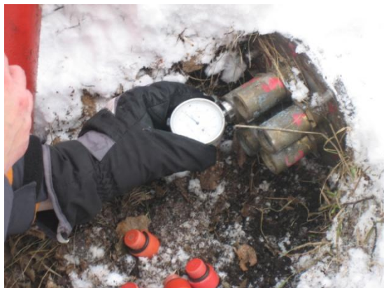
Figura 27 – Estensimetro multibase – versante del monte Leteè (Dorio – LC). Fonte: archivio CMG Arpa Lombardia
