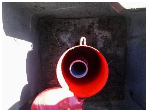
Figura A.40 - Pozzetto di protezione carrabile per testa di tubo piezometrico. Fonte: archivio ARPAL
