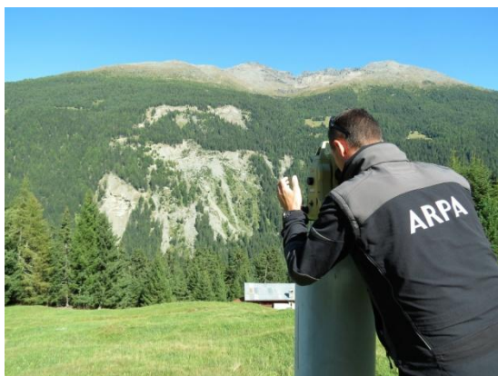
Figura 6 - Esempio di esecuzione misura topografica a controllo del dissesto Ruinon in comune di Valfurva (SO). Fonte: archivio CMG Arpa Lombardia
