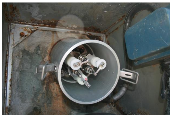
Figura 28 – Estensimetro multibase automatico – loc. Campo Franscia (Lanzada – SO). Fonte: archivio CMG Arpa Lombardia
