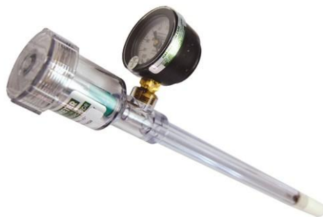
Figura A.43 - Tensiometro a tubo, dotato di vacuometro e capsula ceramica
