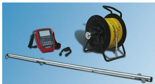
Figura 30 – Sistema incrementale T-Rex per la misura di cedimenti. Fonte: foto Sisgeo S.r.l.
