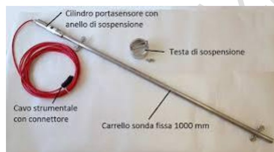
Figura A.32 - sonda inclinometrica fissa Fonte Ditta OTR
