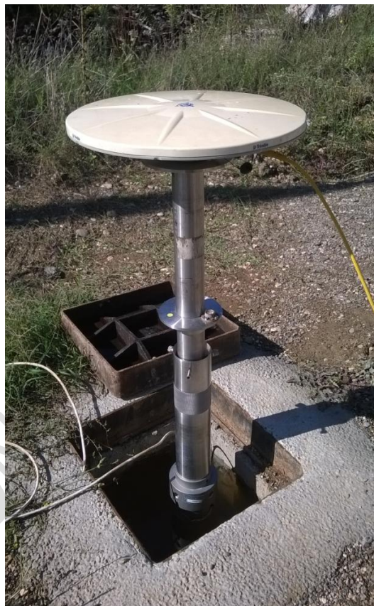
Figura A.14 - Antenna posizionata sulla testa di un inclinometro (Frana di Costa della Gaveta-PZ). Foto da archivio GFI-ISPRA
