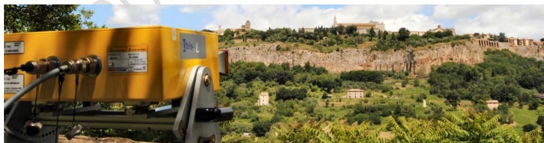
Figura C.19 - Veduta del lato SE della rupe di Orvieto e del pendio argilloso sottostante. In primo piano un radar per misure interferometriche da terra (Fonte: I.A.T. Ingegneria per l'Ambiente ed il Territorio Srl, Roma)
