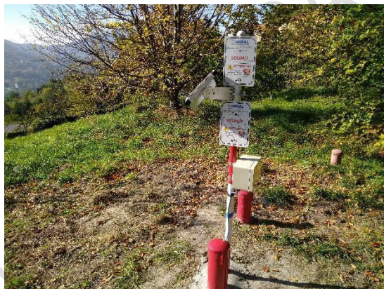
Figura 19 – Pannello solare e datalogger collegato con sonda inclinometrica automatica e piezometro automatico. Fonte: archivio ARPAL
