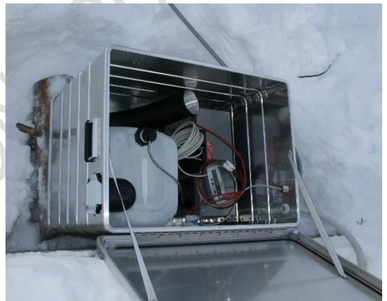
Figura A.53 - Esempio di utilizzo di una cella a combustibile (metanolo) per alimentazione di backup in zone di alta montagna. Fonte: archivio Attività geologiche – Regione Autonoma Valle d'Aosta
