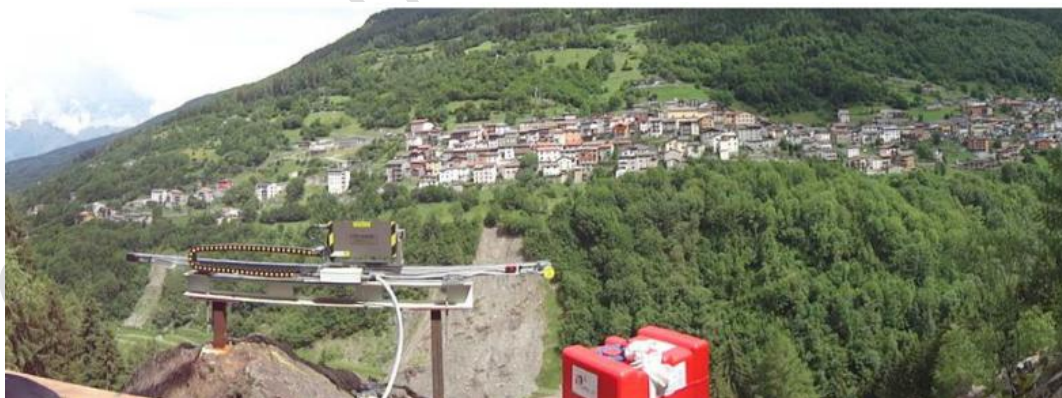
Figura 11 – Monitoraggio periodico con radar interferometrico. Località Valle di Savio Comune di Savio dell'Adamello (BS). Fonte: archivio CMG Arpa Lombardia
