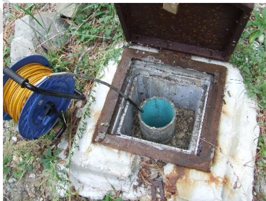
Figura A.41 - Sonda freatimetrica manuale per il rilievo della soggiacenza della falda. Fonte: archivio ARPAL
