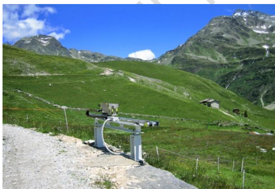
Figura 12 – Monitoraggio periodico con radar interferometrico del versante del Mater in Comune di Madesimo (SO). Fonte: archivio CMG Arpa Lombardia
