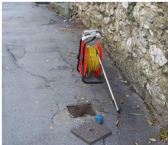
Figura A.31 - Sonda servo-accelerometrica biassiale e cavo da 50 m: ogni sonda con il proprio cavo costituisce un sistema di misura unico non intercambiabile. Fonte: archivio ARPAL
