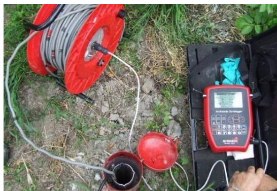
Figura 17 – Datalogger in funzione durante l'acquisizione dei dati inclinometrici. Fonte: archivio ARPAL
