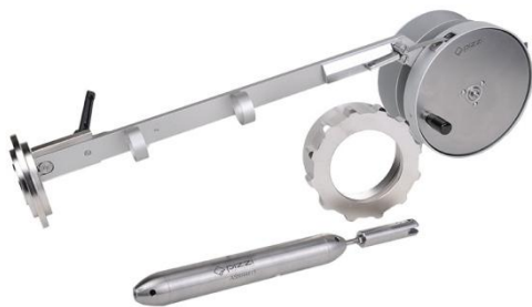
Figura 31 – Assestimetro con alette sporgenti e retrattili. Fonte: foto Pizzi Instruments S.r.l.
