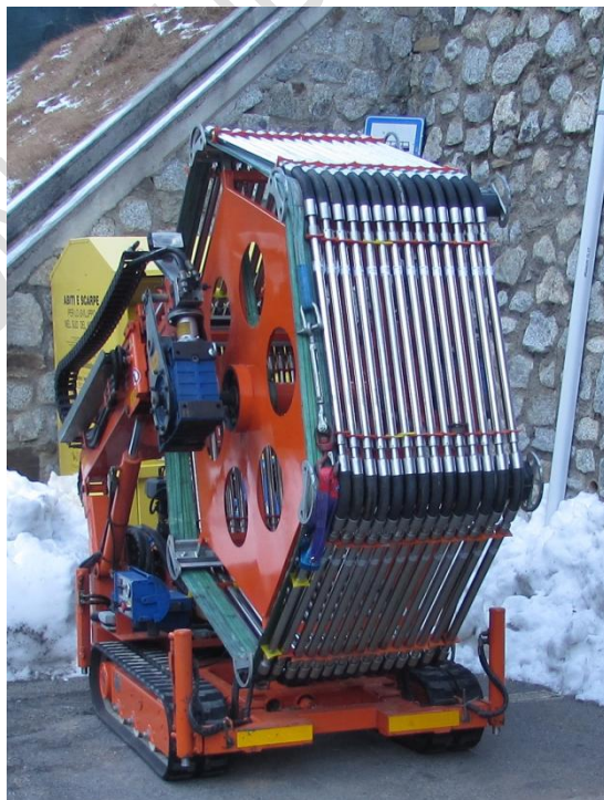
Figura 23 – Esempio di colonna multiparametrica costituita da una catena di sensori montata su un reeler prima dell'installazione (Fonte: archivio CMG Arpa Lombardia)
