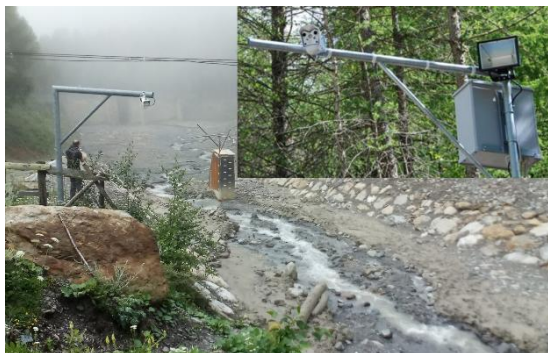
Figura A.25 - Esempio di installazione di webcam e relativo faro (Rio Gadria, BZ). Fonte: CNR IRPI
