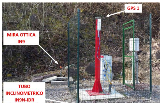
Figura 2 – Esempio di ridondanza dei sistemi di misura del movimento del dissesto di Idro (BS). Sensore GNSS con acquisizione in tempo reale, mira ottica afferente al sistema di misurazione topografica manuale e tubo inclinometrico con cavo TDR ( time domain reflectometry ). Fonte: archivio CMG Arpa Lombardia
