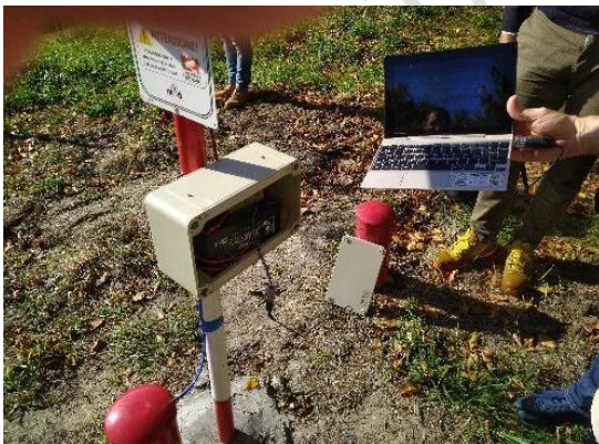
Figura 20 – Scarico dati inclinometrici da sensore servo-accellerometrico biassiale. Fonte: archivio ARPAL
