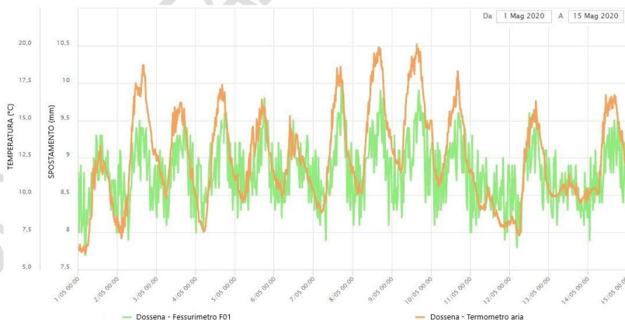
Figura 5 - Influenza della temperatura (in arancione) sulle misure fessurimetriche (in verde) dello strumento installato sulla chiesa di Dossena (BG). Fonte: archivio CMG Arpa Lombardia
