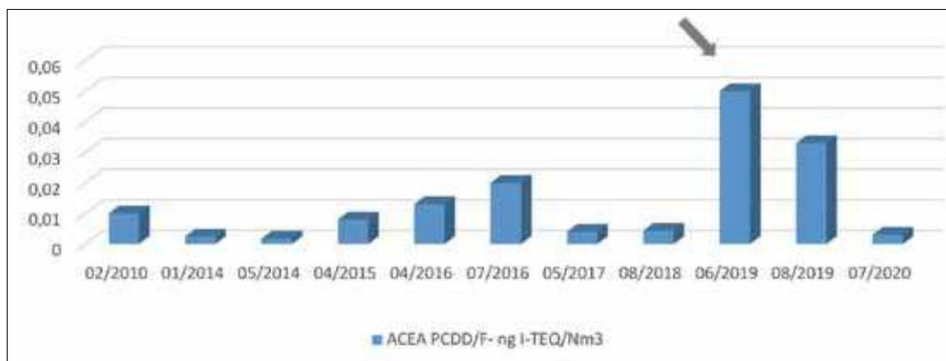
Fig. 3. Concentrazioni di PCDD/PCDF in ng-I-TEQ/Nm<sup>3</sup> relativi al camino E1 del termovalorizzatore ACEA.
