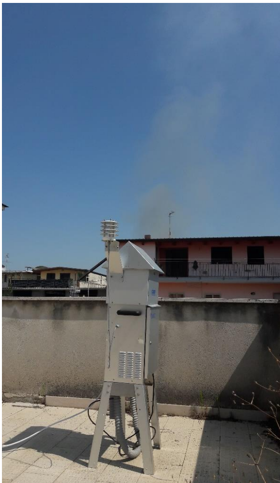
Foto 4: Campionatore ad alto volume usato dai dipartimenti territoriali per l'individuazione delle diossine aero disperse.
