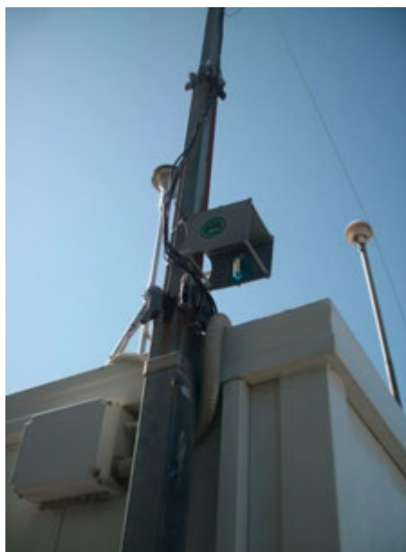
Figura 8. Radiello®, (fonte http://www.amsanalitica.com/it/dettaglio-prodotto/items/radiello.html ) Box con campionario installato a Falconara Alta
