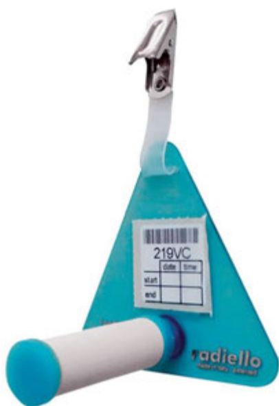
Figura 8. Radiello®, (fonte http://www.amsanalitica.com/it/dettaglio-prodotto/items/radiello.html ) Box con campionario installato a Falconara Alta
