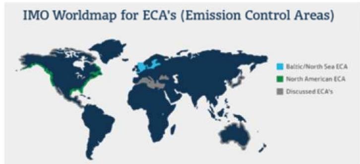
**Fig. 1 - Aree a controllo delle emissioni secondo il regolamento dell'organizzazione marittima internazionale (IMO) - Protocollo MARPOL 1997**
