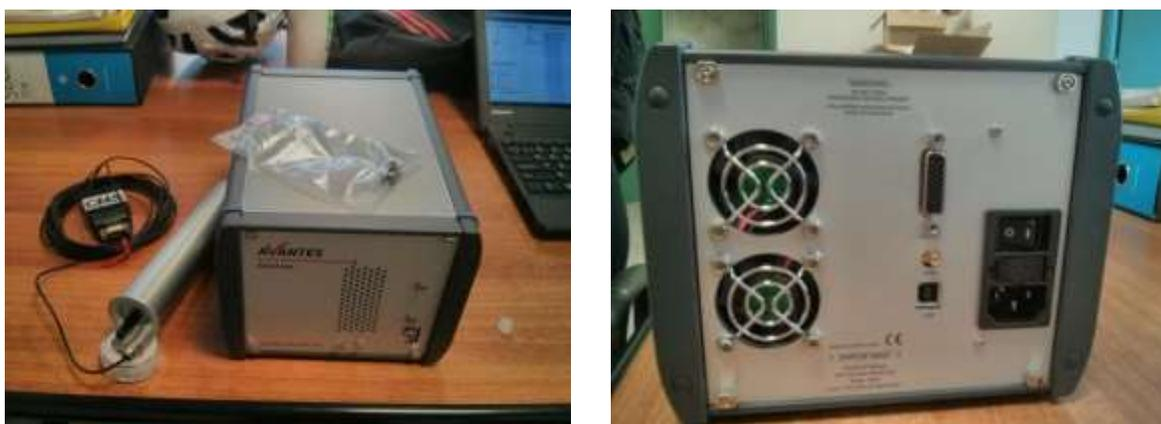
Figura 6.3: (a) Spettrometro Avantes ULS2048LTEC (fronte) con telescopio Schreder J1004.
