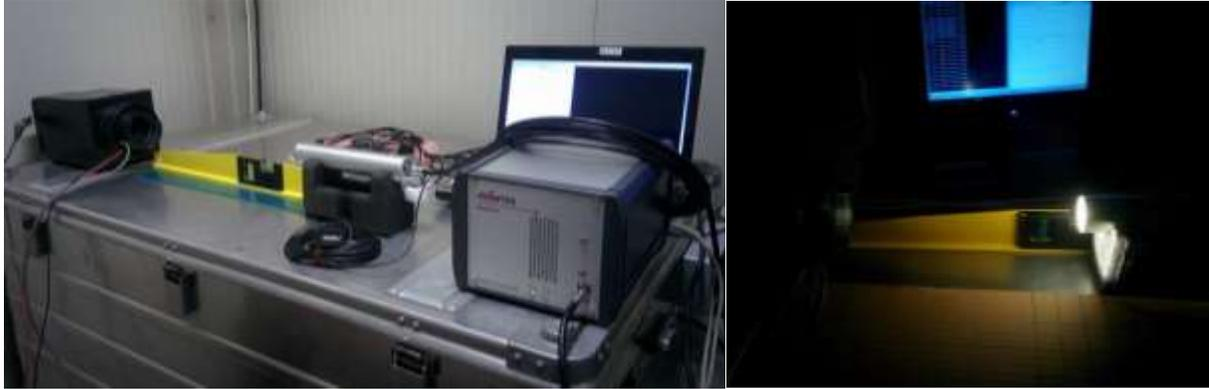
*Figura 6.6: A sinistra, panoramica della configurazione strumentale adottata per i test di non-linearità. A destra, dettaglio della configurazione, durante un controllo per il corretto allineamento tra fascio della lampada e ottica d'ingresso del sistema spettrometrico*
