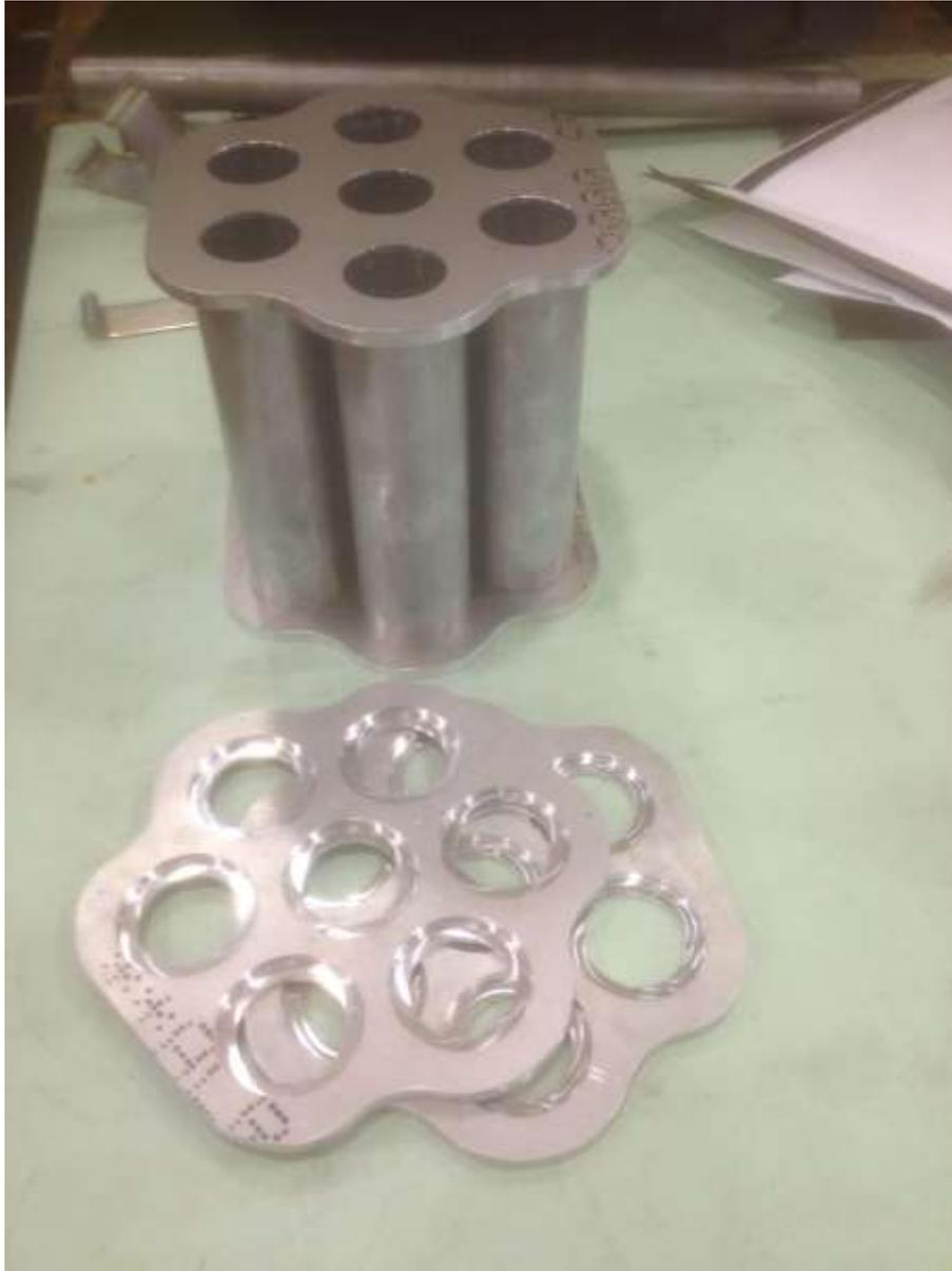
*Figura 5.3: Il sistema in fase di realizzazione presso l'officina meccanica del Dipartimento di Fisica dell'Università degli Studi di Milano. In evidenza le flange con cui vengono tenuti assieme i cilindri che contengono le cartucce.*
