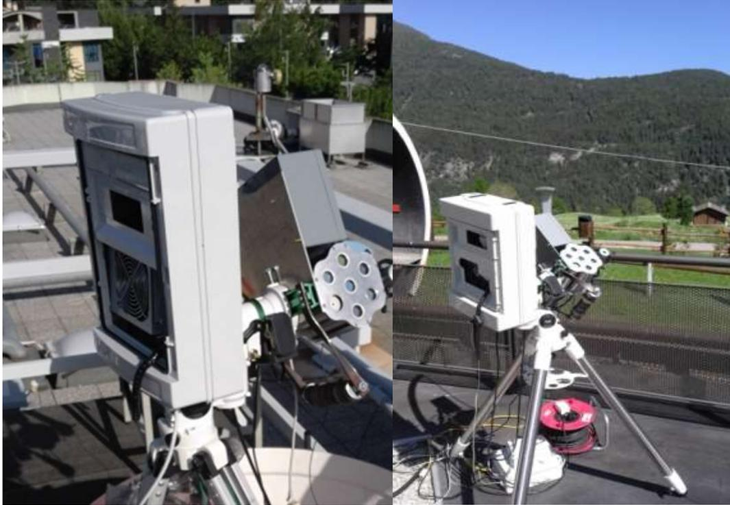
*Figura 5.17: i due ARBOL installati presso ARPA VdA (a sinistra) e presso l'OAVdA (a destra) durante una giornata di normale funzionamento. Da notare sul lato sinistro rispetto allo strumento la presenza del box contenente l'alimentatore, i controlli motori.*
