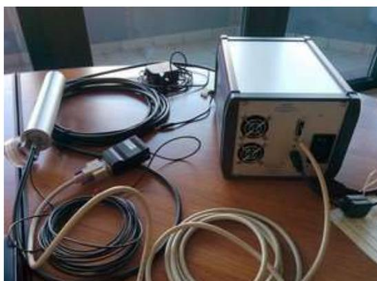
*Figura 6.5: Spettrometro collegato tramite cavo seriale al comando elettronico dello shutter.*
