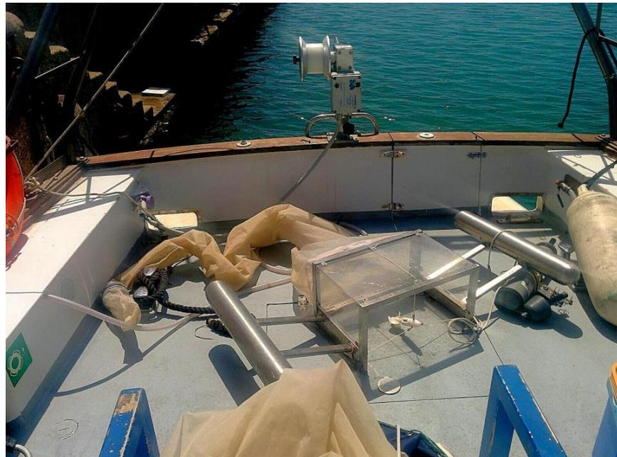
È costituito da una bocca rettangolare metallica da cui si diparte il cono di rete che termina con un bicchiere raccogliitore e da due galleggianti laterali, esterne alla bocca, che lo mantengono in superficie.
