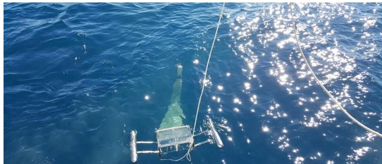
Dopo le misure dei parametri chimico-fisici il retino viene calato lentamente dall'imbarcazione e lasciato in galleggiamento, assicurandolo al battello tramite una cima lunga 50-70 m in modo da lasciarlo fuori dalla scia dell'imbarcazione e dalla turbolenza provocata dalle eliche dei motori
