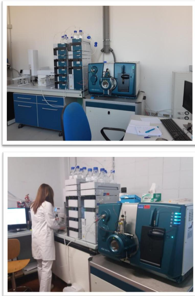
Figura 1: Spettrometri di Massa LC-MS/MS in uso presso la U.O. Laboratorio di Milano-sede laboratoristica di Monza (foto sopra) e presso la UO Laboratorio di Brescia (foto sotto).
