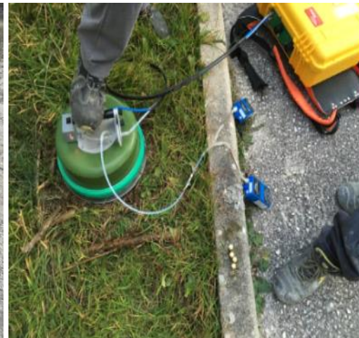
CAMERA DI ACCUMULO
