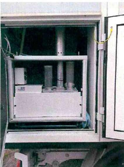
La foto precedente mostra il Polverimetro presente all'interno del Laboratorio Mobile per la determinazione delle Polveri PM10. Il laboratorio mobile ha in dotazione anche due strumenti di nuova generazione per la ricerca in aria ambiente di sostanze organiche volatili e di sostanze solforate, di seguito descritti:
