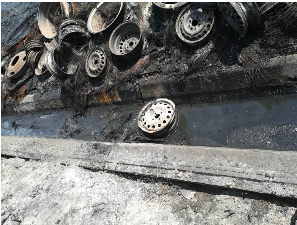
Punto di prelievo delle acque di spegnimento confluite nella canaletta di raccolta delle acque meteoriche
