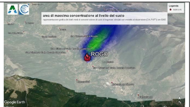
Rappresentazione grafica della simulazione della diffusione dei fumi al livello del suolo con modello CALPUFF (ore 02:00 del 03.07.2019)
