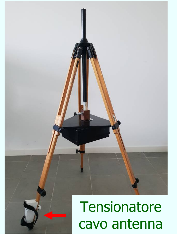
Cavalletto modificato per ospitare il motore
