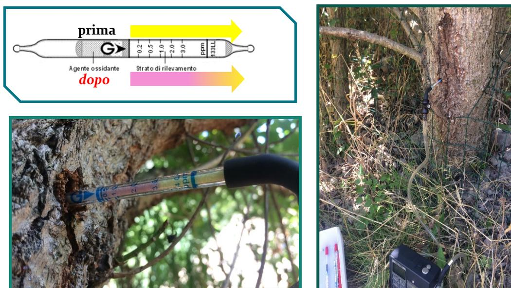
Figura 8 Campionamento in vivo tramite fiala colorimetrica
