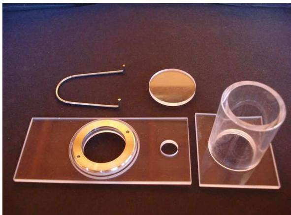
**Figura 2: Camere di sedimentazione**
