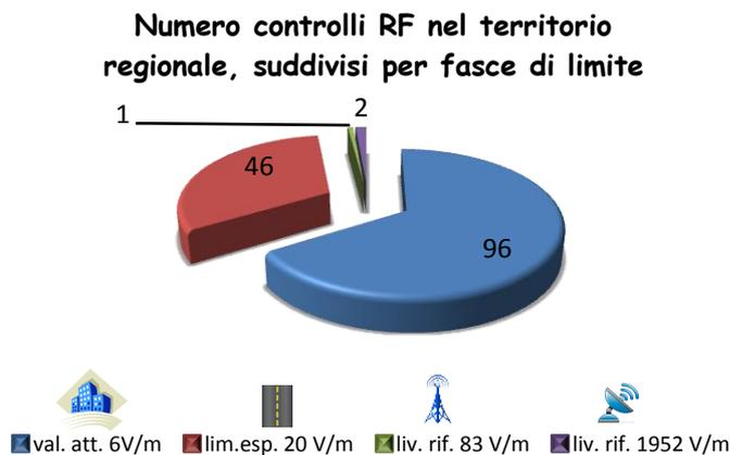
al numero di controlli, cioè di interventi nel corso dei quali vengono effettuati una o più misure, eseguiti presso siti ai quali si applica il valore di attenzione (6 V/m), il limite di esposizione (20 V/m), il livello di riferimento di 83 V/m e 1952V/m, (quest'ultimo come valore di picco). Gli ultimi due livelli di riferimento riportati, si
