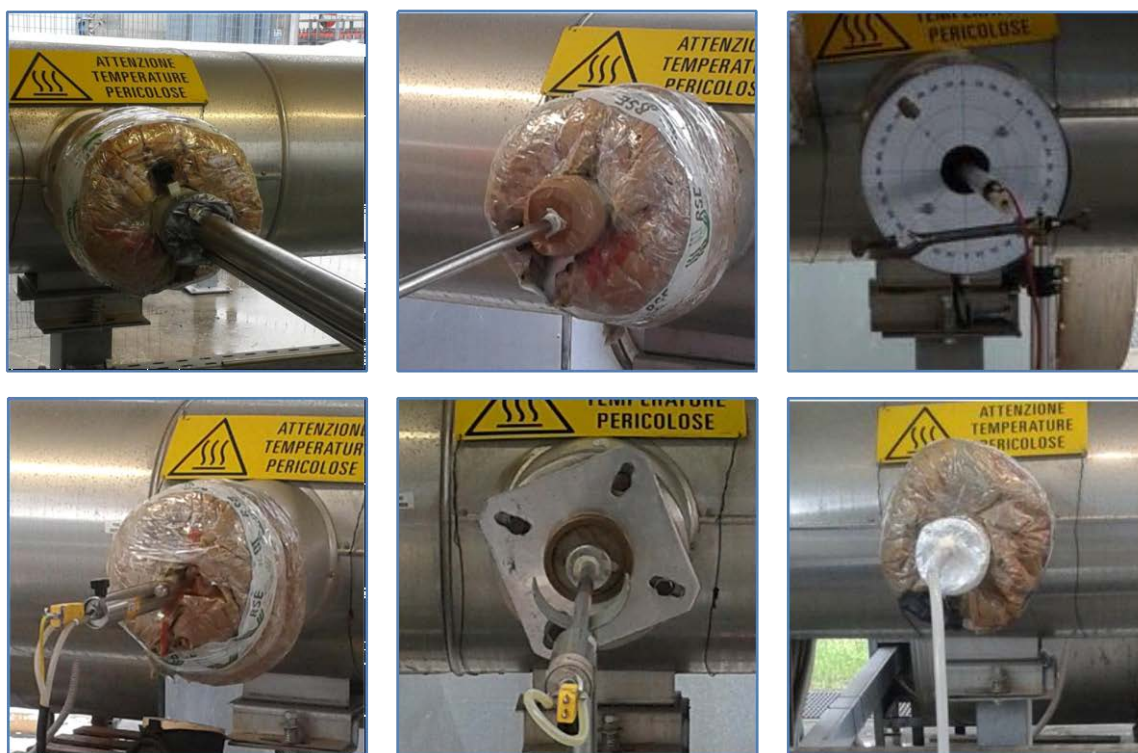
Figura 6 –Dettagli dell'allestimento dei bocchelli di prova
