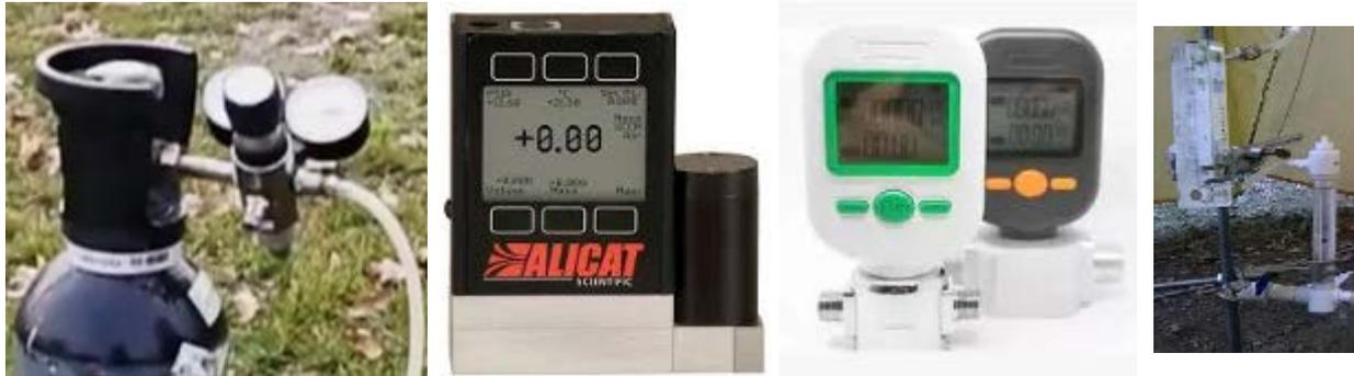
A volte, nel caso di basse portate si corre il rischio di avere un aumento della concentrazione di contaminante tale da deprimere il gradiente di concentrazione all'interfaccia suolo-aria, mentre alte portate abbassano la concentrazione all'interno della camera e portano addirittura ad una sovrastima del flusso emissivo (in particolare per suoli caratterizzati da alta permeabilità), ma riducono l'umidità relativa, minimizzando i fenomeni di condensazione.
