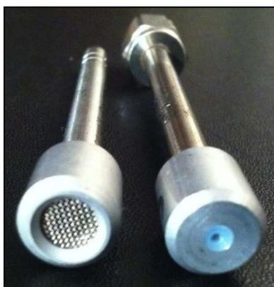
Il *Water Membrane Sampler*<sup>TM</sup> è un campionatore passivo assiale di tipo a membrana (Fig. 11). Tale campionatore è costituito da una vial in cui è presente del carbone attivo e da un tappo costituito da una membrana non porosa in polidimetilsilossano (PDMS) attraverso cui i vapori riescono a permeare.
