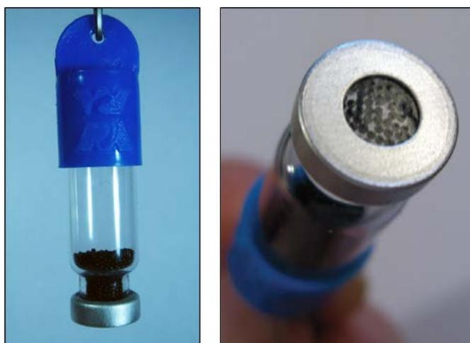
Il vantaggio di questo tipo di campionatore è che evita l'intrusione dell'acqua nel campionatore che, come noto, per alcuni materiali può ridurre le performance del sistema adsorbente. Tale tipologia di campionatore è disponibile in due configurazioni: vial da 1,8 mL (flusso regolare) e vial da 0,8 mL (per campionamenti a basso flusso). Per questa tipologia di
