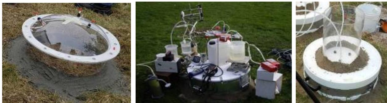
Figura 7 – Schema dei dispositivi collegati ad una camera di flusso dinamica stazionaria
