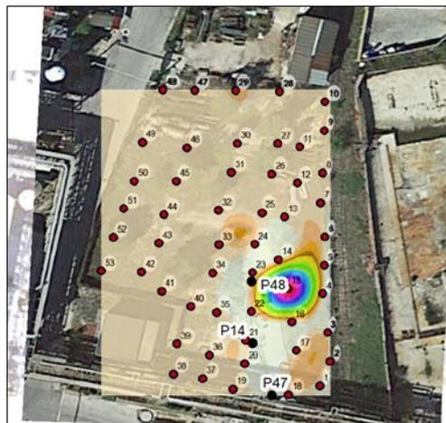
Tra tutti i punti di controllo risultati significativi per flusso ed in cui effettuare i campionamenti ne saranno selezionati, in base alle dimensioni del sito, un numero non inferiore a tre da aumentare in funzione dell'estensione dell'area, indicativamente di 1 punto ogni 2500 m<sup>2</sup> (50 m x 50 m).
