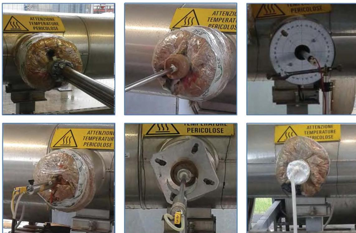
Figura 6 –Dettagli dell'allestimento dei bocchelli di prova
