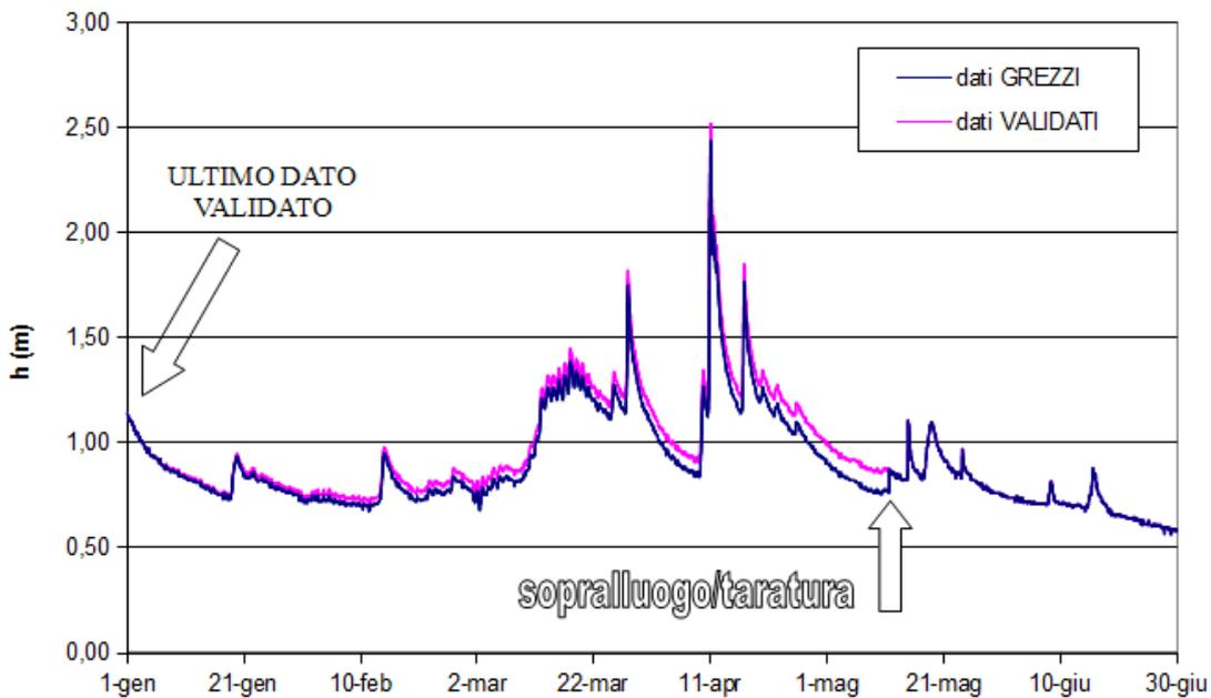
Figura 17: confronto tra livello idrometrico prima (linea blu) e dopo l'applicazione dell'offset (linea viola).
