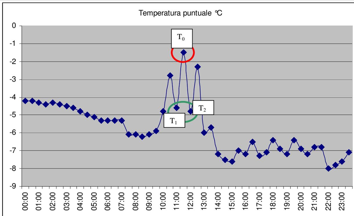
Figura 10:  $T_0$  temperatura istantanea all'istante 0 confrontata con la temperatura all'istante precedente  $T_1$  e con l'istante successivo  $T_2$ .
