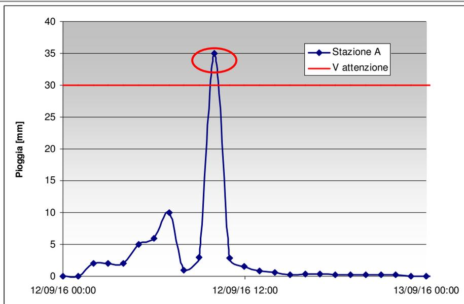
Figura 2: esempio di una serie di dati di pioggia a 1 ora con un valore sospetto, cerchiato in rosso, in quanto superiore al valore di attenzione  $V_a$  posto uguale a  $30,0 \text{ mm h}^{-1}$ .
