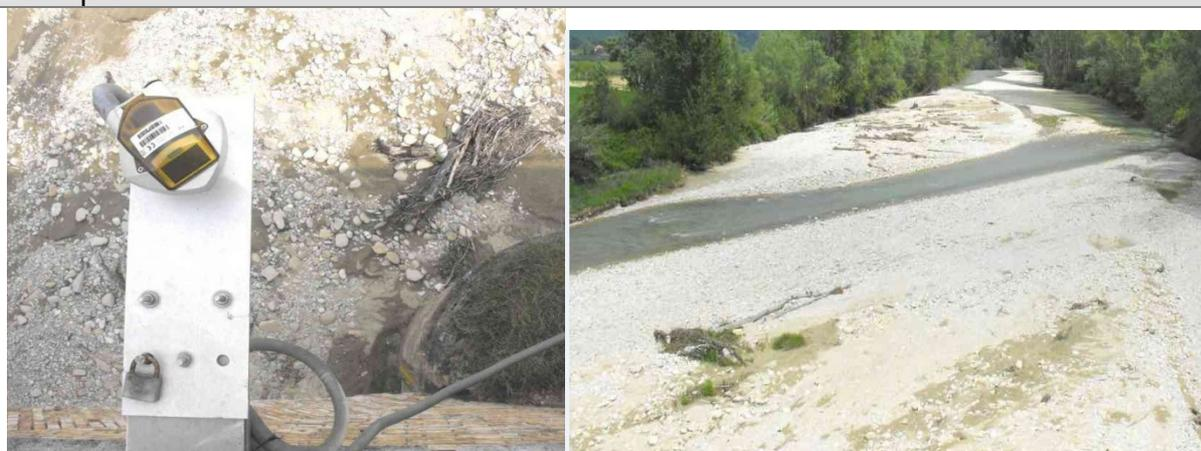
Figura 14: alveo a carattere torrentizio in fase di magra: il flusso d'acqua divagando rende inutilizzabili i dati letti dal sensore idrometrico.
