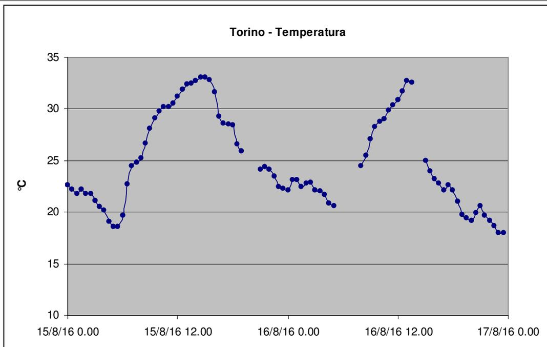
Figura 9: grafico dei dati di temperatura dell'aria con dati istantanei mancanti.
