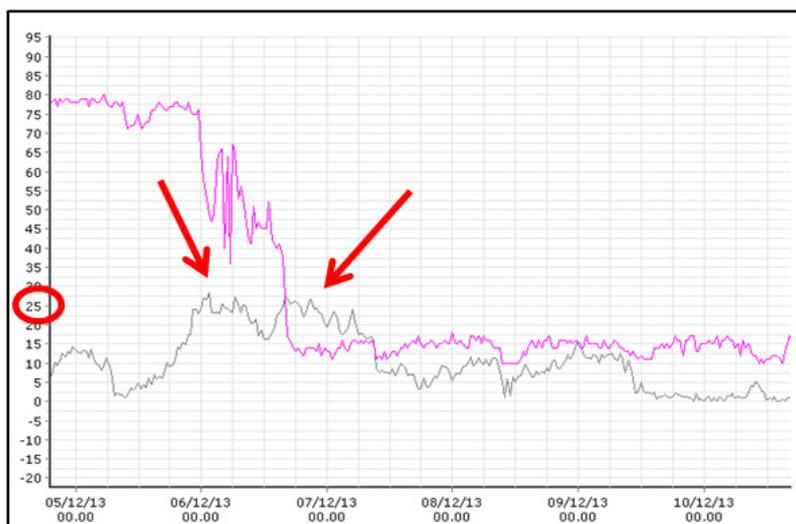
Figura 30: confronto tra l'andamento del manto nevoso (in viola) e la velocità del vento (in grigio). Si evidenzia come il forte vento registrato sia responsabile dell'erosione completa del manto nevoso.
