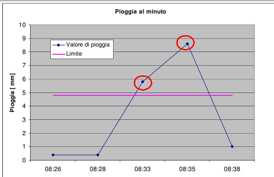
Figura 1: esempio di dati di pioggia a 1 minuto con valori (cerchiati in rosso) da scartare perché superiori al valore soglia L posto pari a = 4,8 mm al minuto (soglia valida per i pluviometri PMB25).
