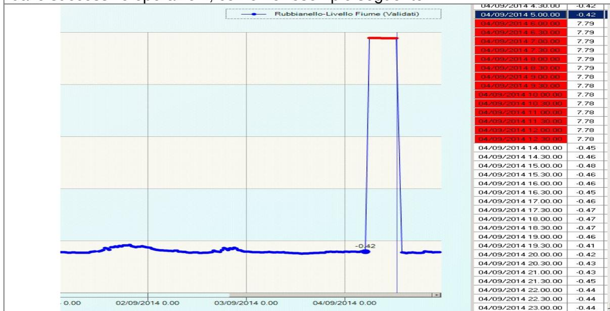
Figura 15: idrogramma con dati errati evidenziati in rosso, vengono flaggati con 3 (dato errato).
