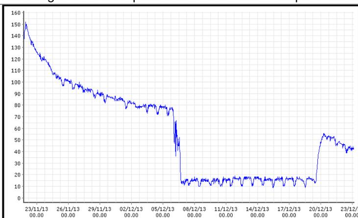
Figura 31: anomalo comportamento del manto nevoso, attribuibile in prima analisi ad azione terza (ad es., rimozione del manto nevoso con macchinari).
