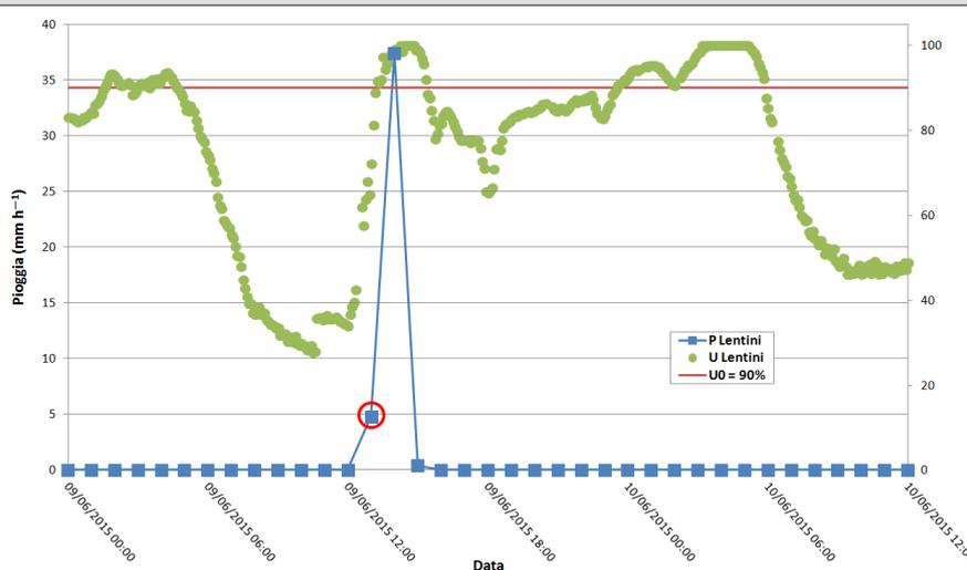
Figura 5: esempio di confronto incrociato tra dati di pioggia a 1 ora e dati di umidità relativa a 5 minuti della stazione Lentini, dalle ore 00:00 del 9 giugno 2015 alle ore 12:00 del 10 giugno 2015. Il dato di pioggia P non nulla con associato un valore di umidità relativa U inferiore al valore di soglia  $U_0$  (cerchiato in rosso) è da considerarsi un dato sospetto.
