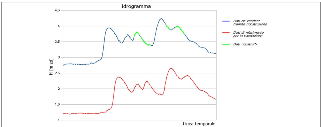
Figura 13: in alto idrogramma con dati mancanti (blu) confrontato con idrogramma completo di altra stazione idrometrica, in basso idrogramma con dati ricostruiti (verde) confrontato con idrogramma completo di altra stazione idrometrica
