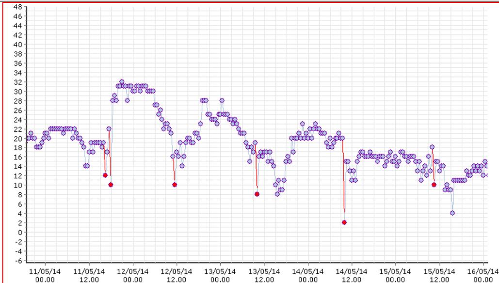
Figura 27: in rosso sono indicati i valori invalidati nell'ambito del controllo di variazione anomala.
