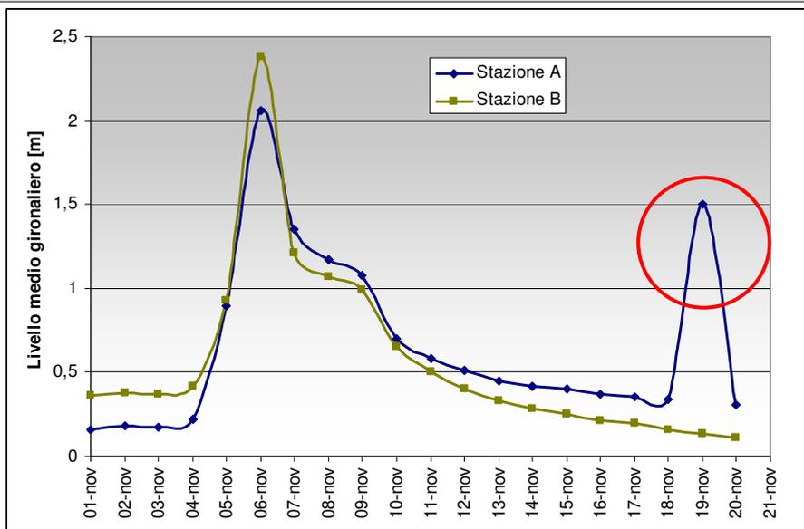
Figura 20: confronto tra idrogrammi di più stazioni idrometriche ubicate lungo la stessa asta fluviale: evidenziato nel cerchio rosso il dato errato.
