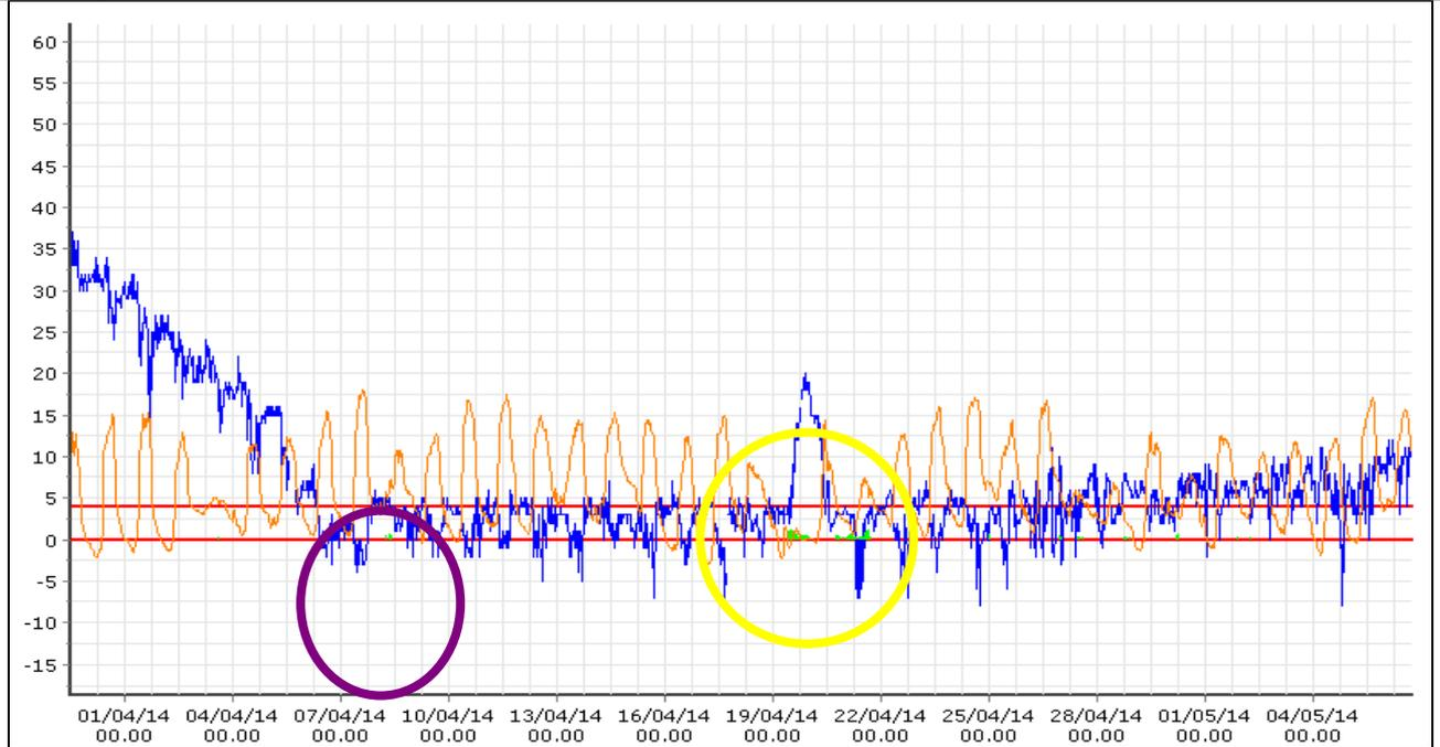
Figura 29: andamento dell'altezza di neve al suolo (in blu) confrontato con l'andamento delle temperature (in arancione) e le precipitazioni liquide provenienti dal pluviometro riscaldato (in verde); le linee rosse orizzontali indicano la soglia di 4 °C e quella di 0 °C.
