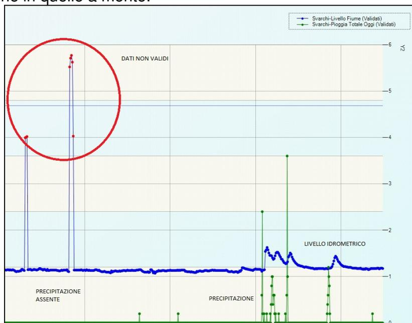
Figura 19: confronto tra il livello idrometrico e la precipitazione misurata a monte della sezione idrometrica.
