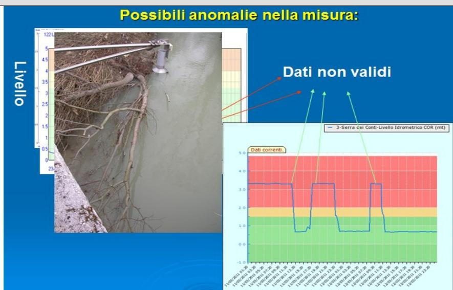
Figura 16: idrogramma con dati errati dovuti a piante sotto l'area di lettura del sensore idrometrico.
