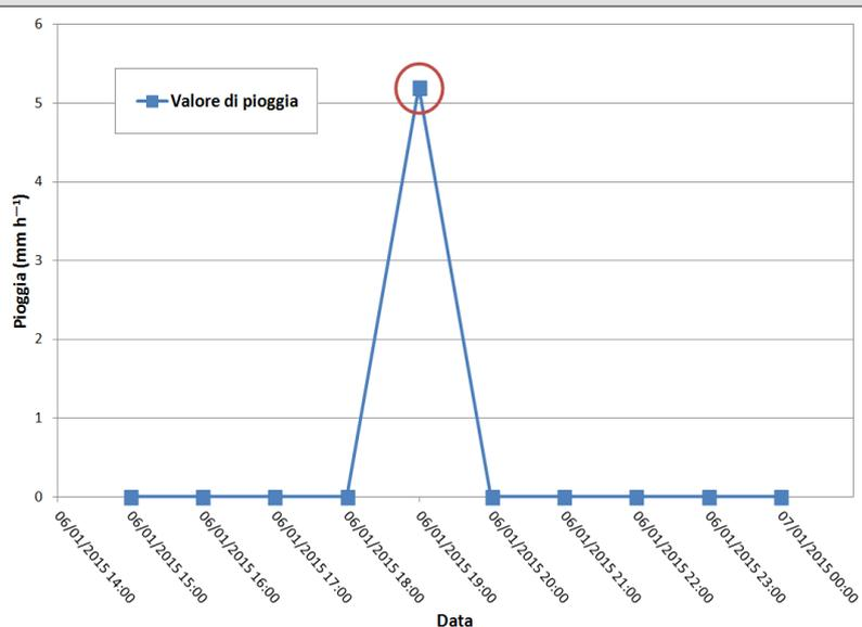
Figura 3: esempio di serie di dati di pioggia a 1 ora con valore sospetto, cerchiato in rosso, in quanto presente all'interno di una sequenza di valori nulli di pioggia.
