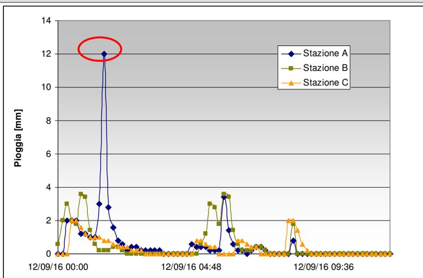
Figura 6: esempio di dati di pioggia istantanea con valore (cerchiato in rosso) errato in quanto notevolmente discordante con l'andamento delle stazioni limitrofe.
