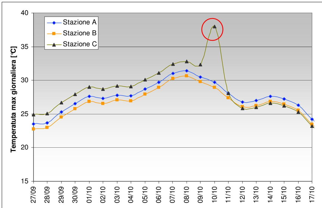
Figura 12: esempio di dati di temperatura massima giornaliera con valore (cerchiato in rosso) errato in quanto notevolmente discordante con l'andamento delle stazioni limitrofe.
