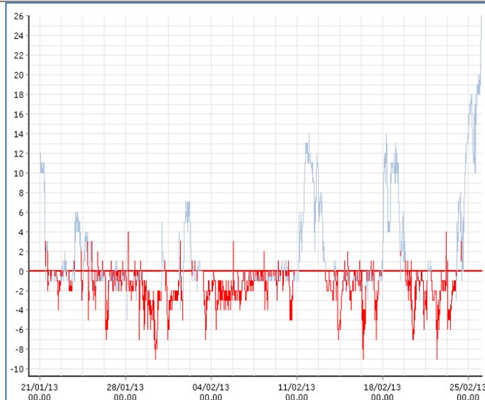
Figura 25: in rosso sono evidenziati i valori inferiori alla  $S_{\min}$  = minimo strumentale, da invalidare.
