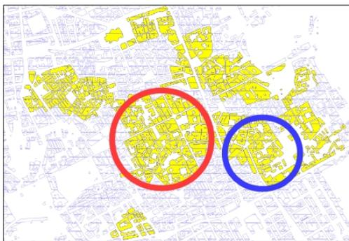
Figura 3 – Gli edifici all'interno del centro storico nei quali vengono superati i 65 dB in facciata (in giallo)
