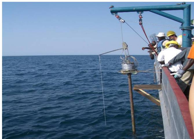
**Figura 46.** Esempio di carotiere a pistone (foto <http://www.geo.arizona.edu/>).
