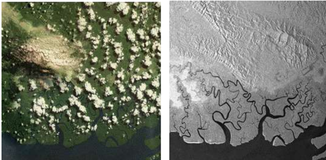
Figura 4. Confronto tra un'immagine acquisita da un sensore passivo ottico (a sinistra) e un'immagine acquisita nello stesso istante da un sensore attivo SAR (a destra). Le onde radar del sensore SAR sono in grado di penetrare attraverso le nuvole.
