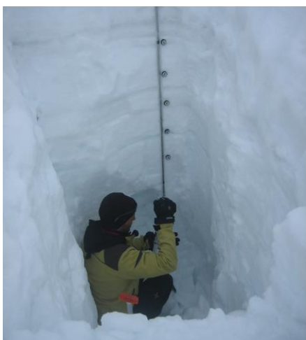
Esecuzione di un profilo stratigrafico presso Sasso Rotondo a inizio estate; si noti l'abbondante spessore.
